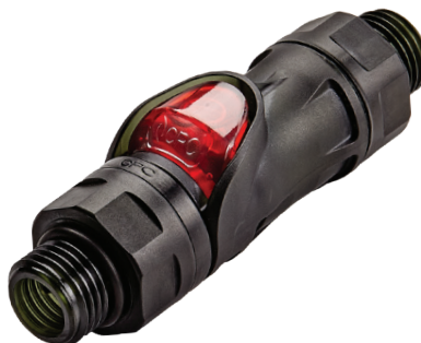
Everis™ PLQ4 1/4 英寸 (6.4 毫米) 标称流量, Cv 值为 1.3 (Kv 1.1) 端头选项: 软管倒钩、锁紧式软管倒钩、SAE、G 螺纹
